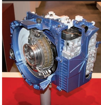
Новая АКП Power Shift оснащена двумя сцеплениями.
